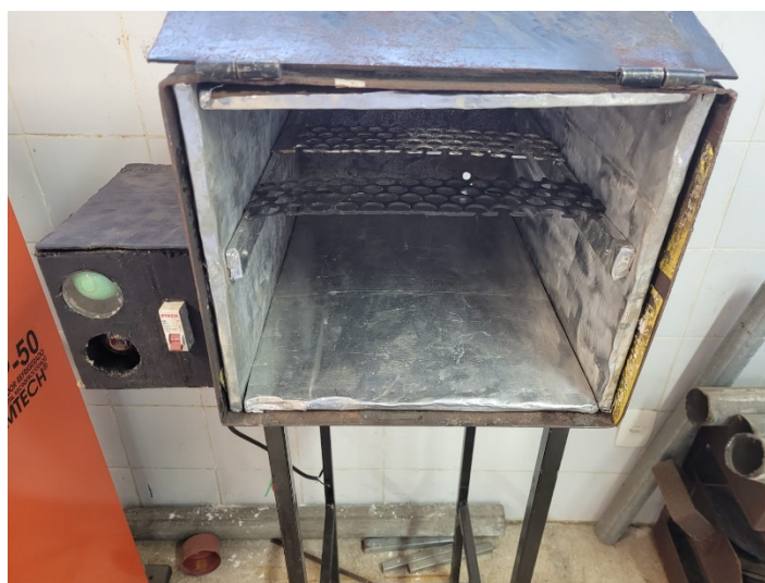
Figura 3 - Estufa de baixo custo para ressecagem de eletrodos revestidos.
